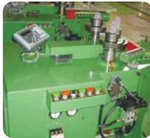
파이프 벤딩기 (Pipe Bending M/C)
